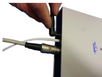
Figure 10 – Branchement de l'alimentation au boîtier électronique
