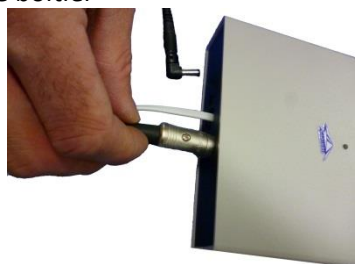
Figure 9 – Connexion du capteur au boîtier électronique
