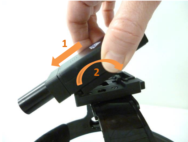
Figure 5 – Mise en place du boîtier pointeur laser
