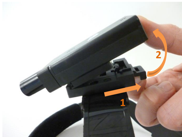
Figure 6 – Retrait du boîtier pointeur laser
