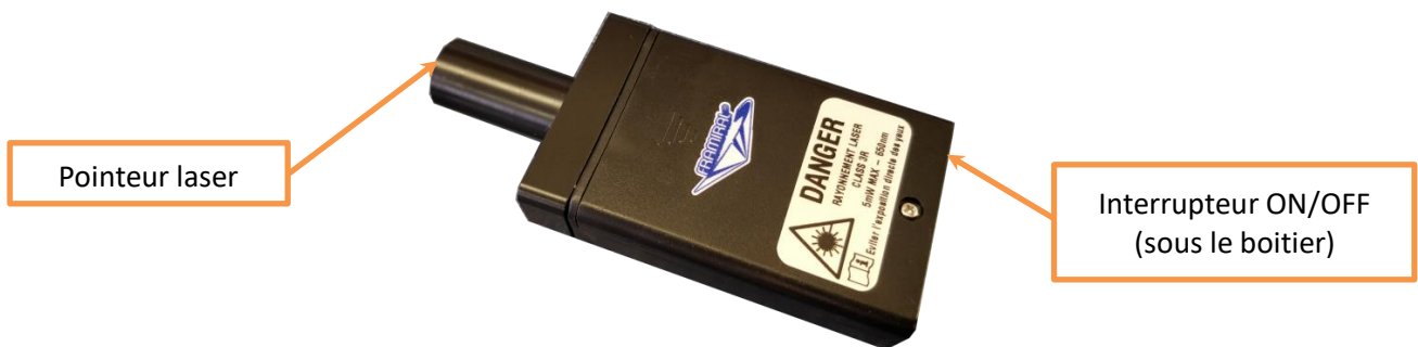
Figure 3 – Boîtier pointeur laser
