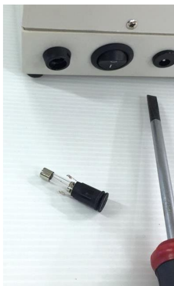
Figure 15 – Remplacement du fusible d'alimentation
