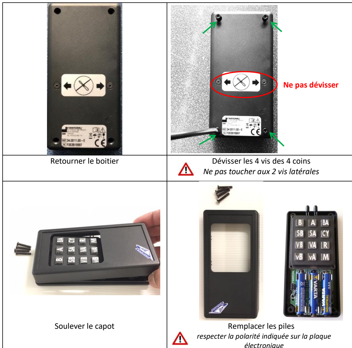
Figure 16 – Remplacement des piles de la télécommande
