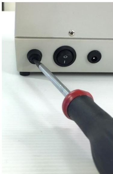
Figure 15 – Remplacement du fusible d'alimentation
