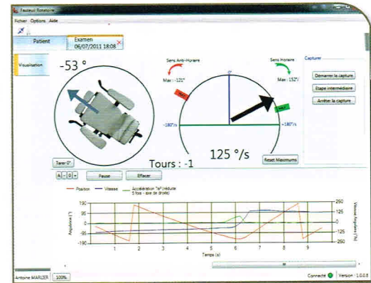
Visualisation des angles, vitesses et accélération du fauteuil
