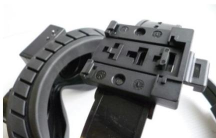
**Figure 5 – Système d'attache du module capteur de mouvement**
