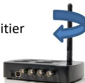
Connecter le récepteur à n'importe quel port USB de l'ordinateur : brancher le cordon USB 2.0 type A/B – REF 16.0034.00 entre le récepteur (réf 16.0033.00) et un port USB du PC.
