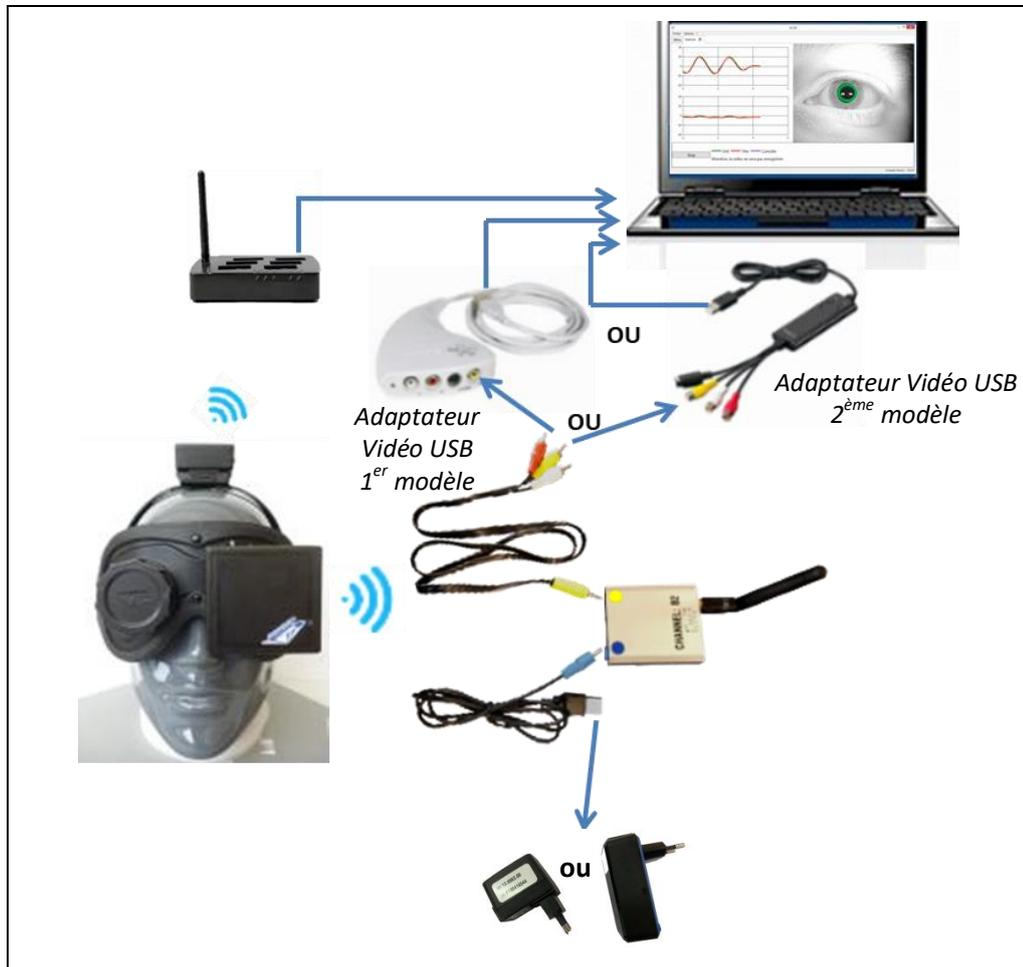
Figure 12 – Branchements avec module caméra sans fil
