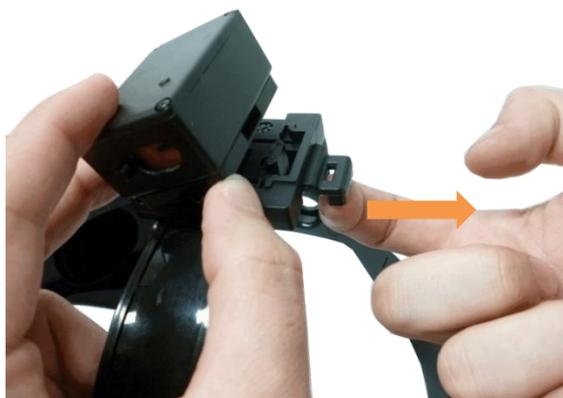
**Figure 7 – Retrait du module capteur de mouvement**
