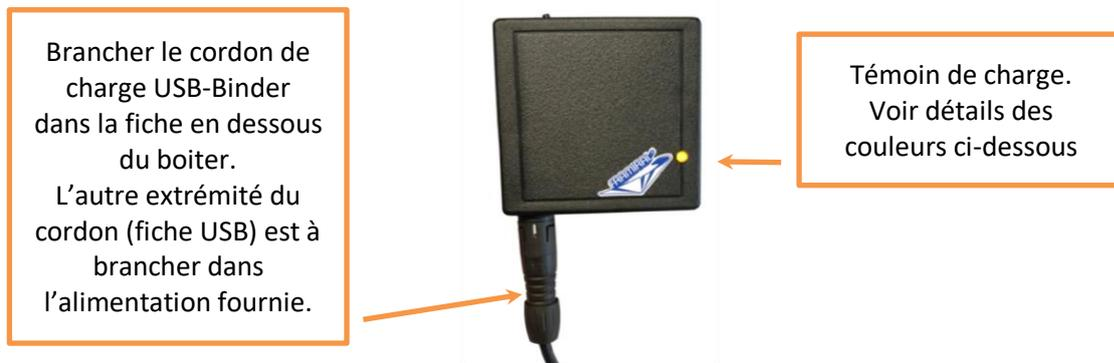
**Figure 3 - Charge du Module caméra**
