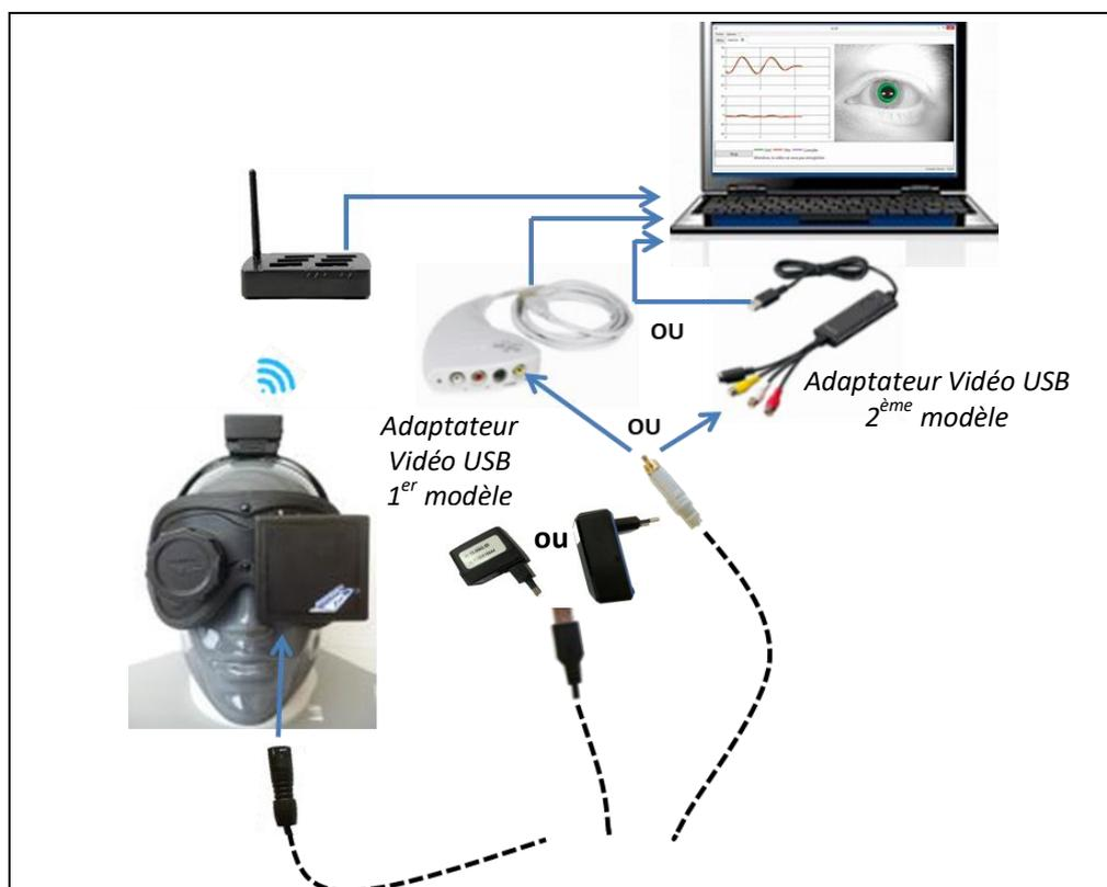
Figure 11 – Branchements avec module caméra filaire
