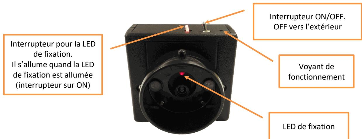
Figure 1 – Module côté caméra
