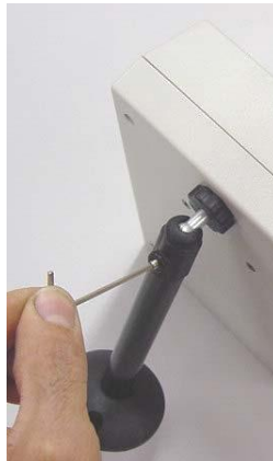
FIGURE 6 - VISSAGE DU PIED
