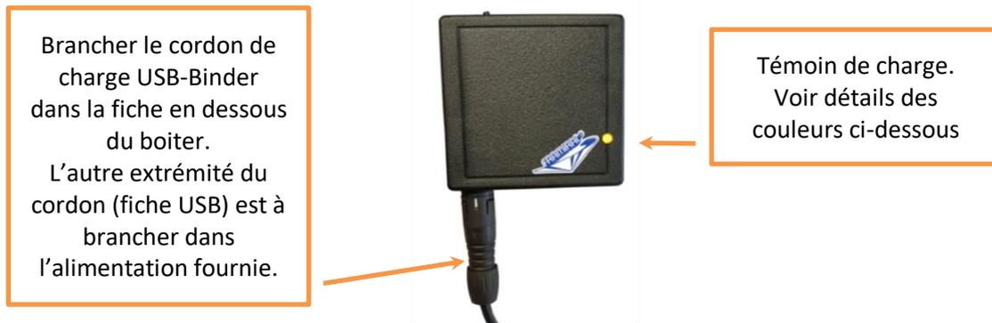
**Figure 3 - Charge du Module caméra**
