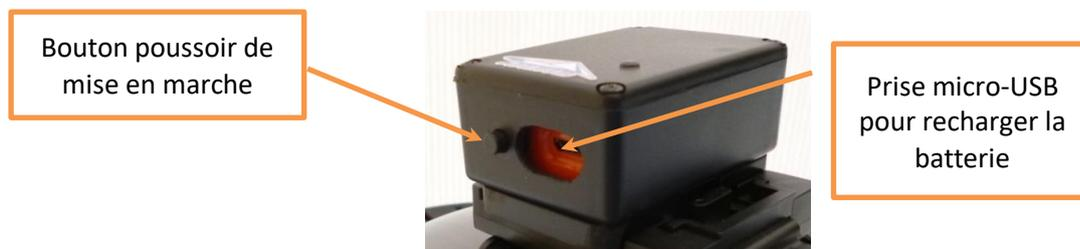
**Figure 4 – Module capteur de mouvement**
