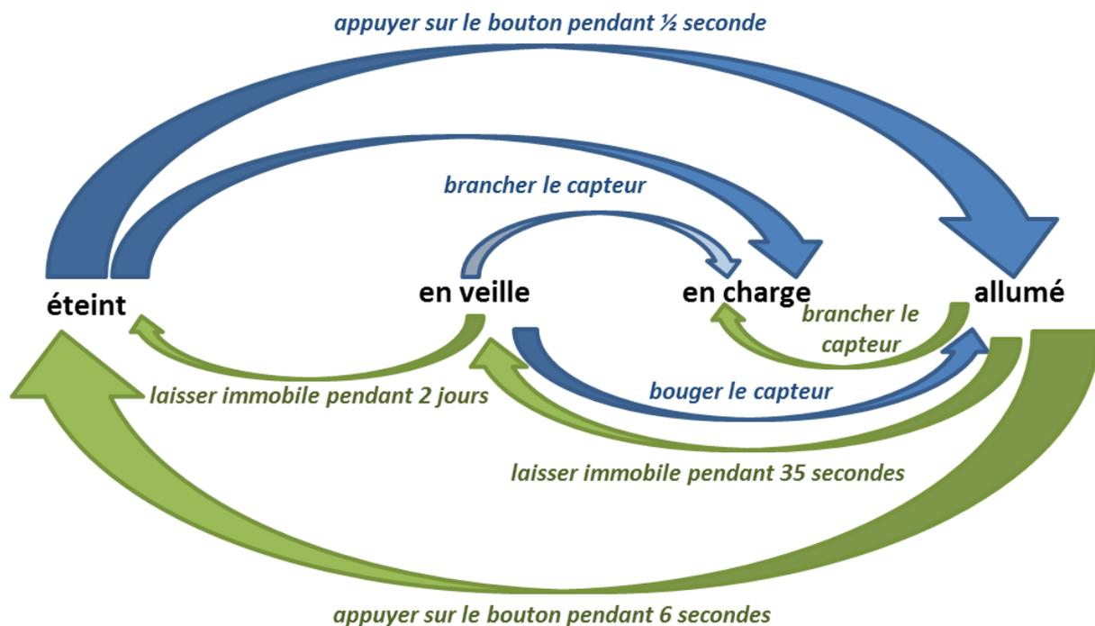
Figure 17 – Fonctionnement du capteur de mouvement
