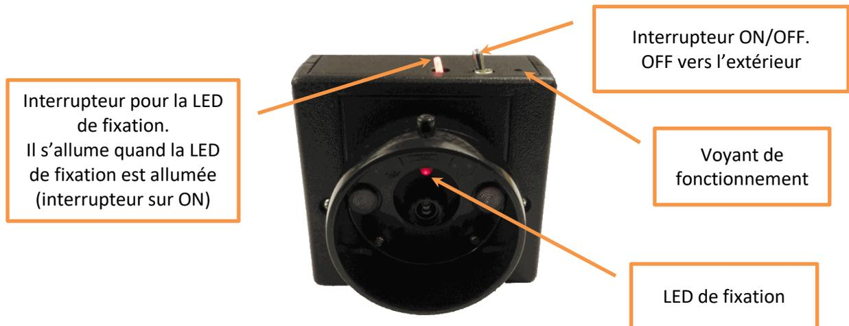
**Figure 1 – Module côté caméra**
