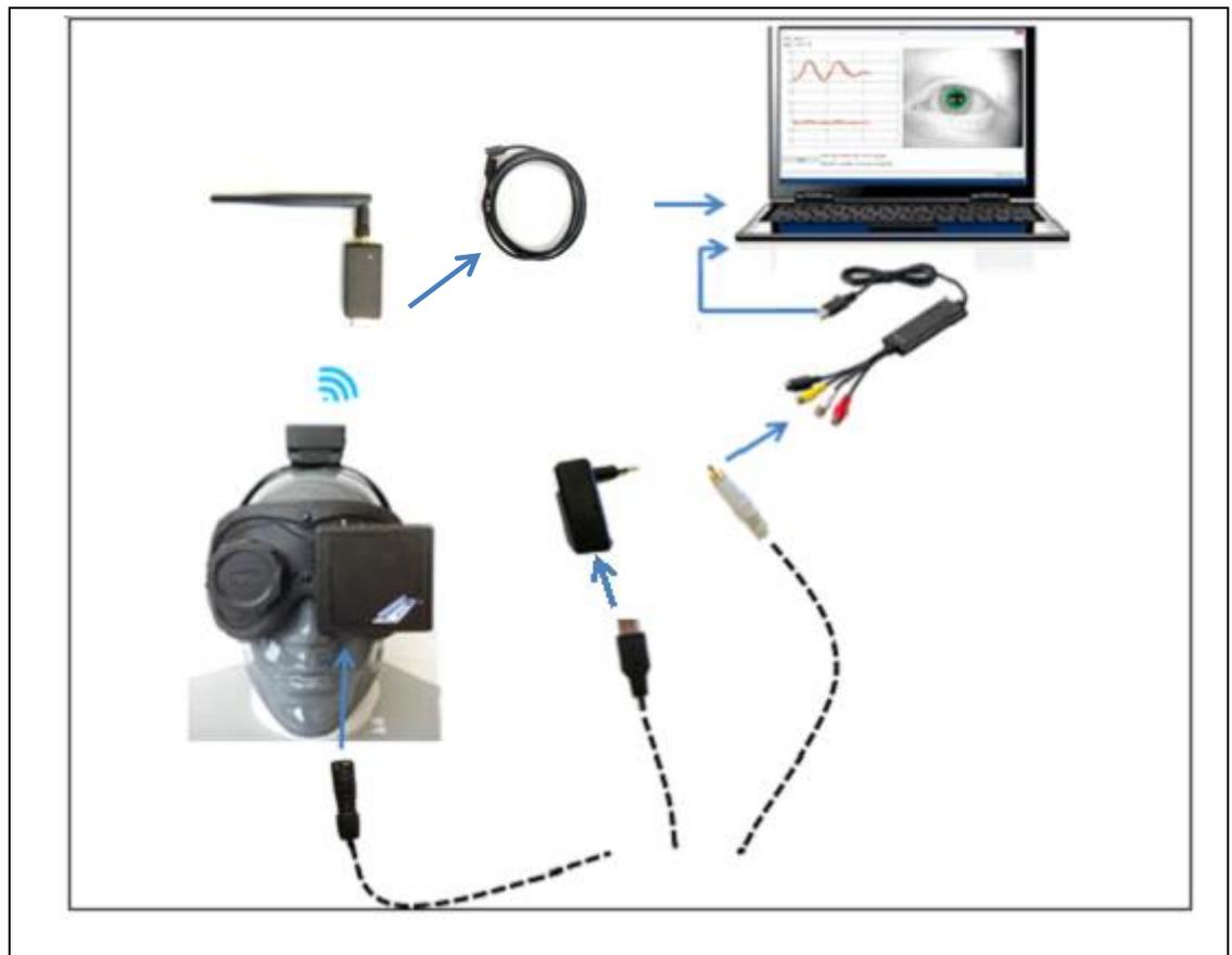
Figure 11 – Branchements avec module caméra filaire
