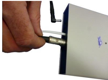
Figure 9 – Connexion du capteur au boîtier électronique
