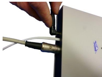
Figure 10 – Branchement de l'alimentation au boîtier électronique
