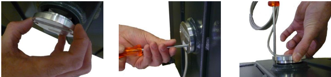
Figure 7 – Mise en place du capteur
