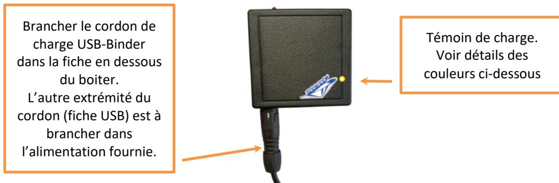
**Figure 3 - Charge du Module caméra**
