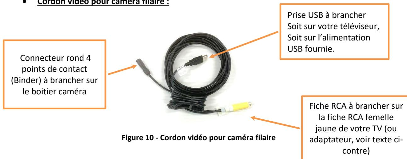
Figure 10 - Cordon vidéo pour caméra filaire
