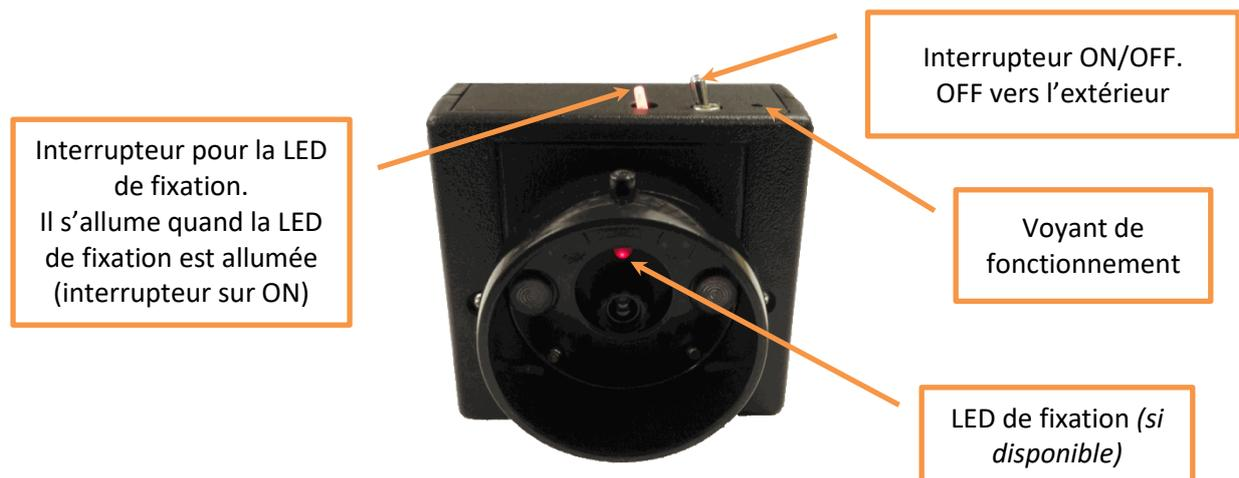
Figure 1 – Module côté caméra
