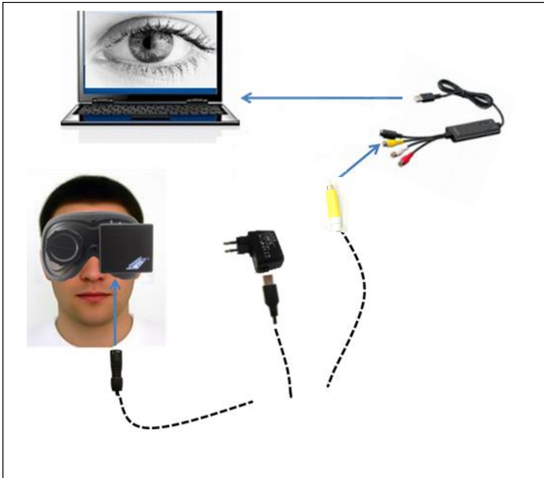
Figure 7 – Schéma de principe du branchement en version filaire sur PC avec adaptateur Vidéo USB
