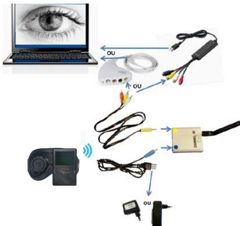
Figure 4 - Branchements pour visualisation PC
