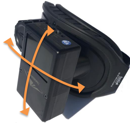
Figure 7 - Réglage de l'écartement des yeux
