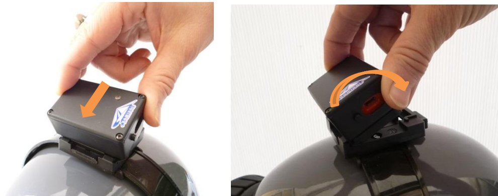
Figure 6 – Mise en place du module capteur de mouvement
