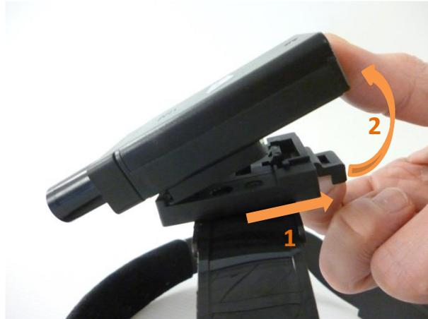
Figure 6 – Retrait du boîtier pointeur laser
