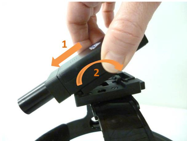
Figure 5 – Mise en place du boîtier pointeur laser
