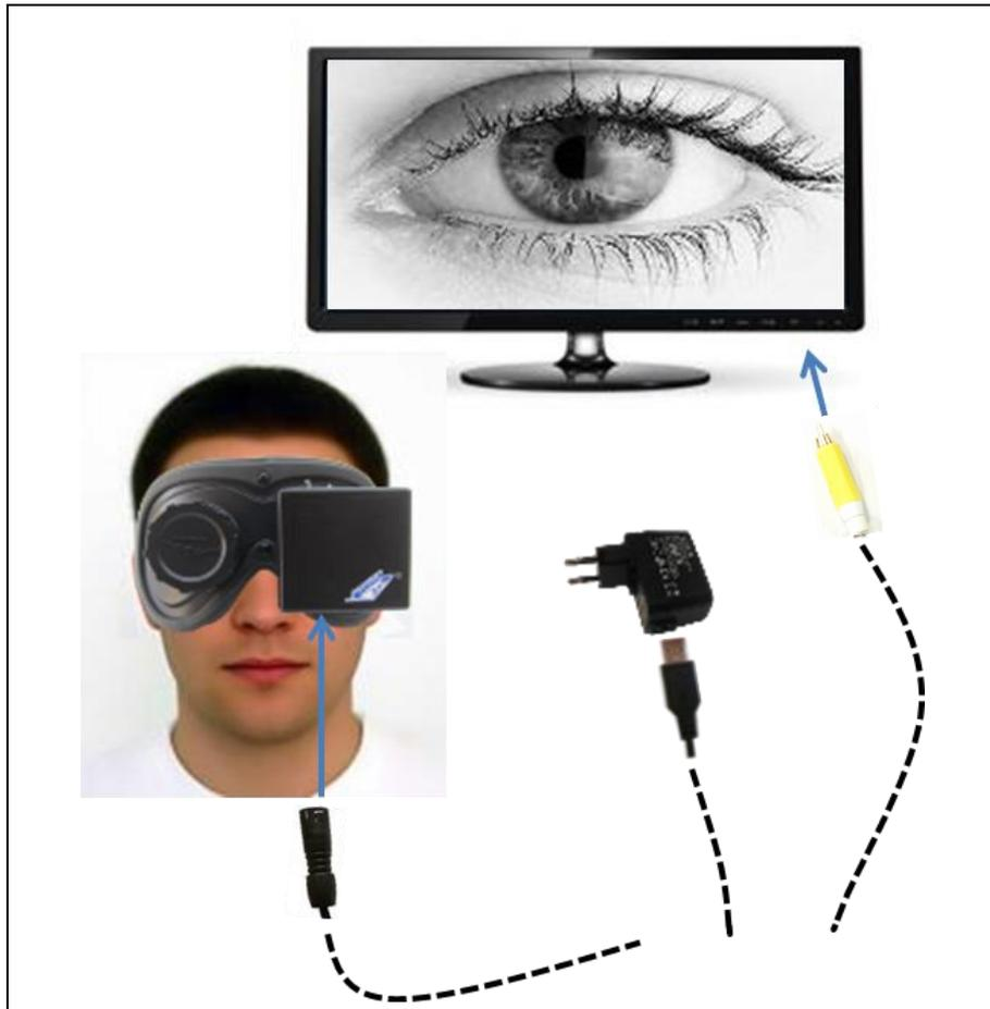
**Figure 6 – Schéma de principe du branchement en version filaire sur téléviseur**
