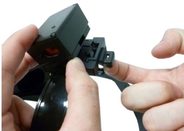
Figure 6 – Retrait du module capteur de mouvement
