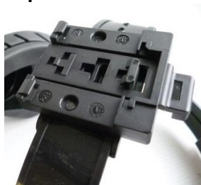
Figure 4 – Système d'attache du module capteur de mouvement
