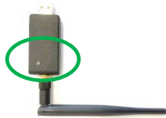
Récepteur REF 16.0018.01 Côté LED
