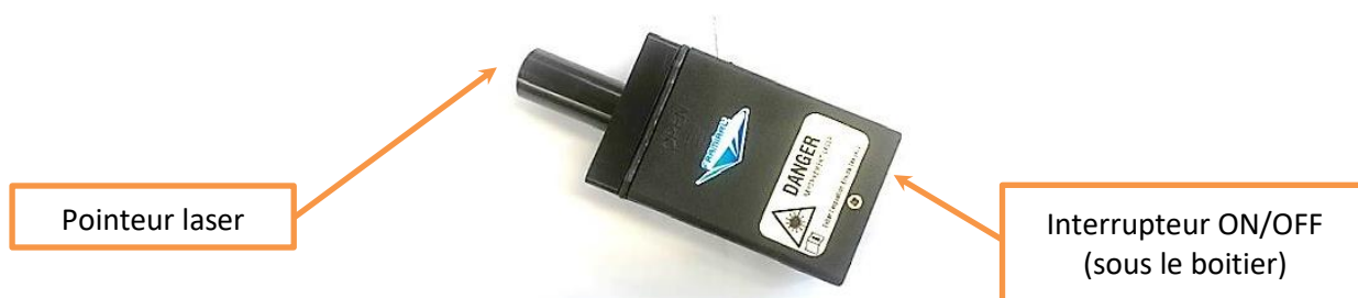
Figure 3 – Boîtier pointeur laser
