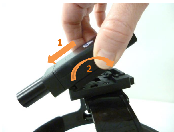
Figure 5 – Mise en place du boîtier pointeur laser
