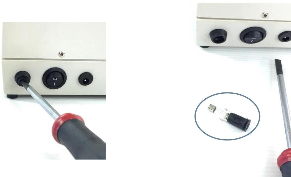
Figure 9 - Remplacement du fusible
