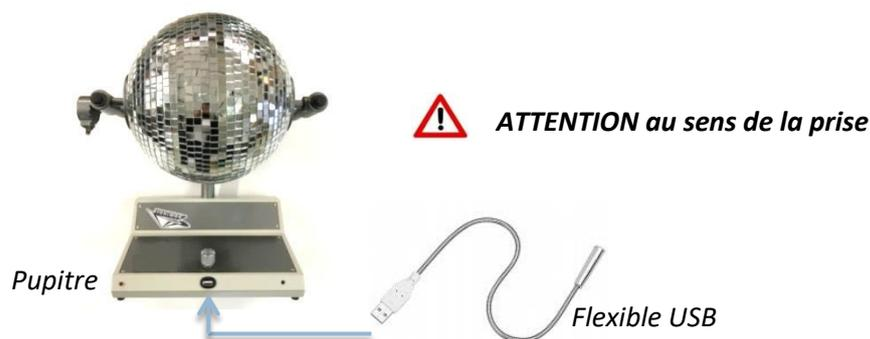
L'embout du flexible (USB Mâle) se branche sur le connecteur USB Femelle à l'avant du pupitre.
