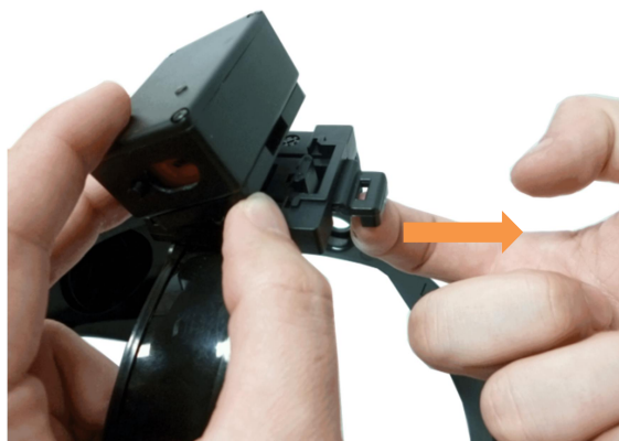
Figure 7 – Retrait du module capteur de mouvement
