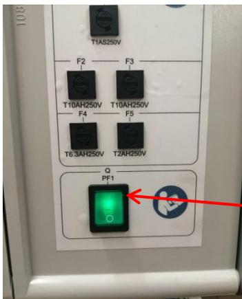
**Section Q/PF1:** Interrupteur général permettant d'allumer et d'éteindre l'équipement. **O** = OFF / **I** = ON. Lorsque l'interrupteur est sur ON un voyant vert est allumé. Un signal sonore est émis lors de l'enclenchement de l'interrupteur sur ON.
