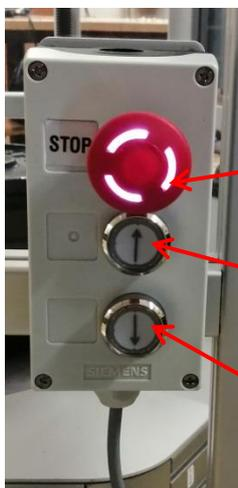
Lorsque le bouton est enclenché celui-ci émet un signal lumineux comme sur la photo ci-contre. Il émet aussi un signal sonore lorsque qu'il est déclenché. Ces signaux s'arrêtent uniquement si le bouton est désenclenché.
