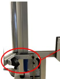
Sur la photo ci contre le système de maintien de la porte et en position verrouillé, la porte est alors en position ouverte et bloquée par le système. Nous retrouvons cette situation lors de la montée et descente du patient.
