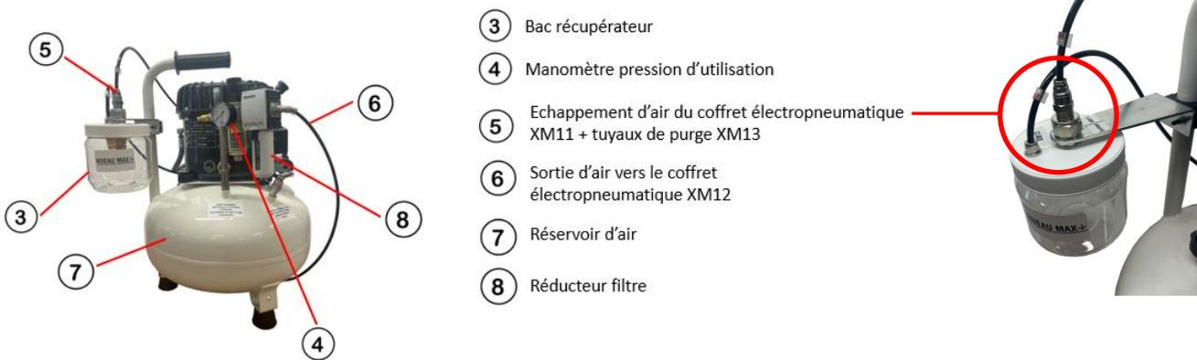
Figure 6 – Compresseur vue de face
