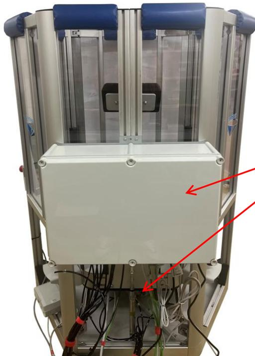
Coffret électropneumatique positionné à l'arrière du dispositif avec ses différents câbles et tuyaux pneumatiques raccordés.
