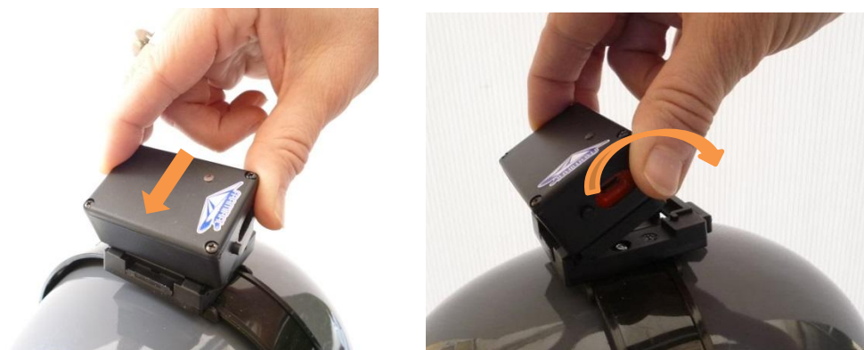
Figure 5 – Mise en place du module capteur de mouvement
