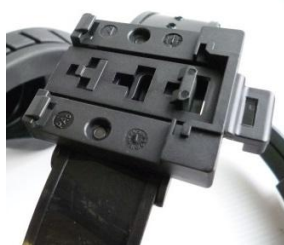
Figure 4 – Système d'attache du module capteur de mouvement
