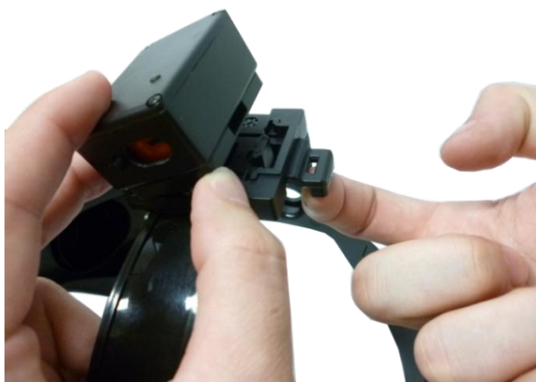
Figure 6 – Retrait du module capteur de mouvement
