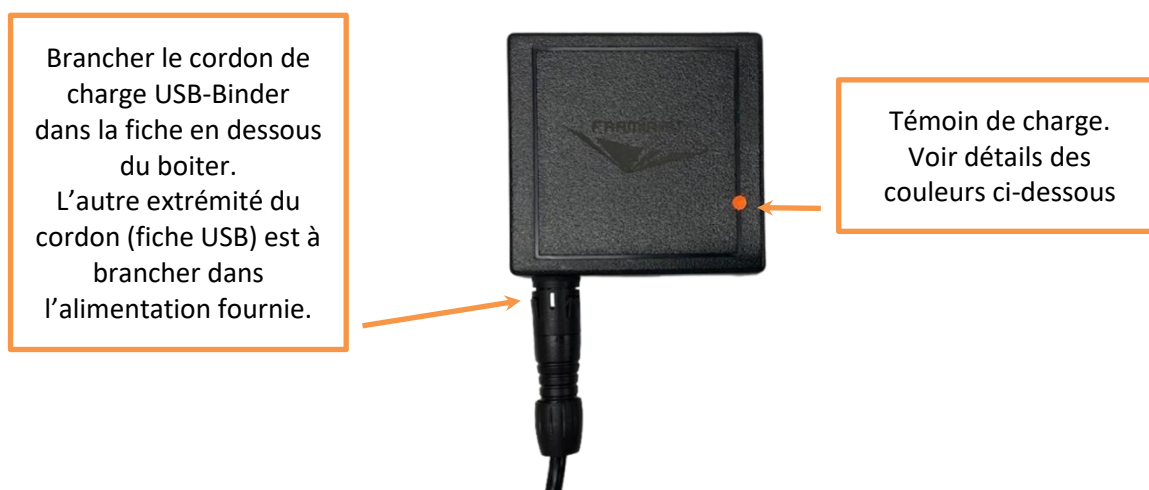
Figure 3 - Charge du Module caméra
