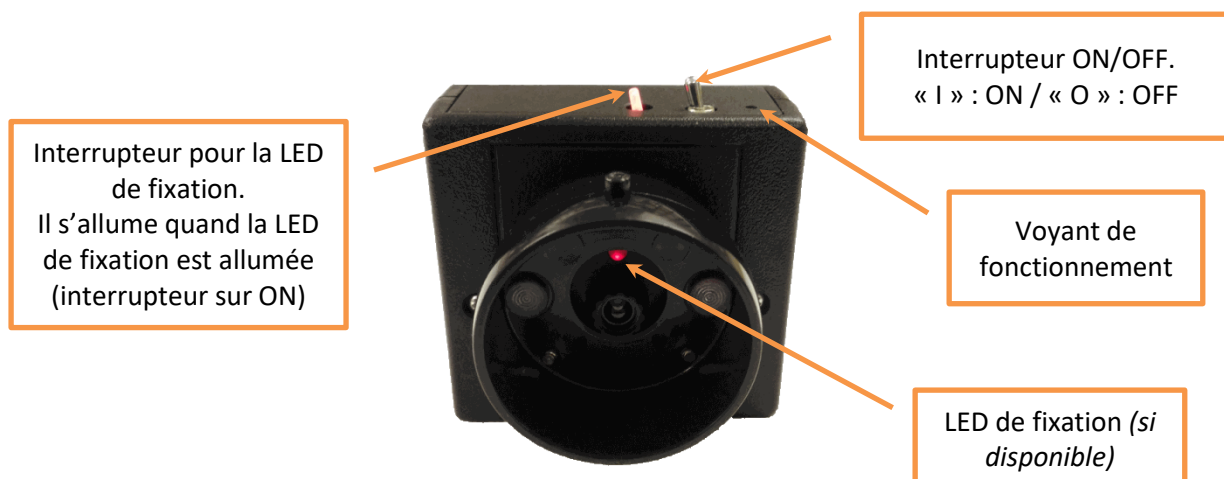
Figure 1 – Module côté caméra
