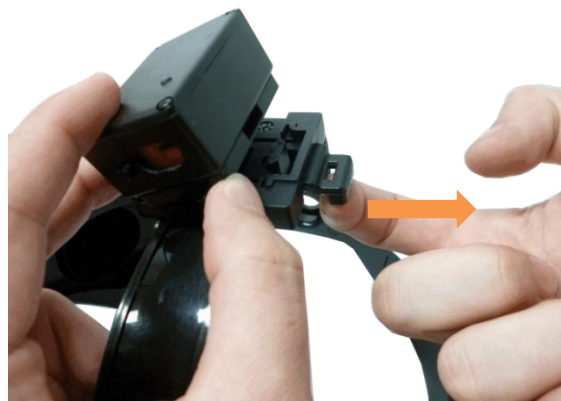
Figure 7 – Retrait du module capteur de mouvement
