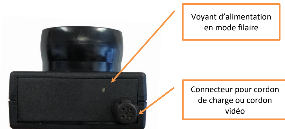
Figure 2 – Module caméra vu de dessous
