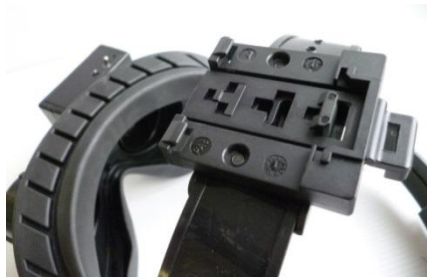
Figure 5 – Système d'attache du module capteur de mouvement
