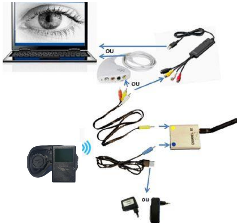
Figure 4 - Branchements pour visualisation PC
